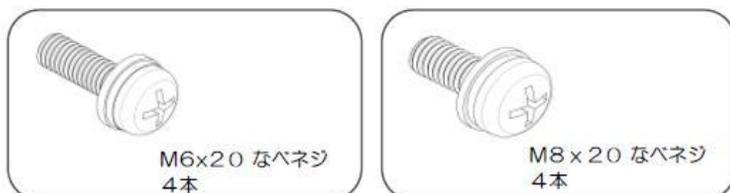
! ディスプレイ取付けには、ディスプレイ付属のネジは使用せず スタンドに付属のネジを使用してください
