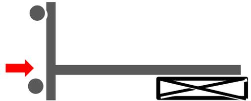
(注) 支柱補強板に負荷がかからないように、ゆっくり倒し、梱包箱等を敷いて支柱部が水平になるようにしてM10ネジを締めてください。
