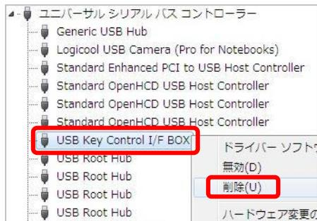
④確認ウィンドウが表示されます。「このデバイスのドライバーソフトウェアを削除する」にチェックを入れて、「OK」ボタンをクリックしてください。
