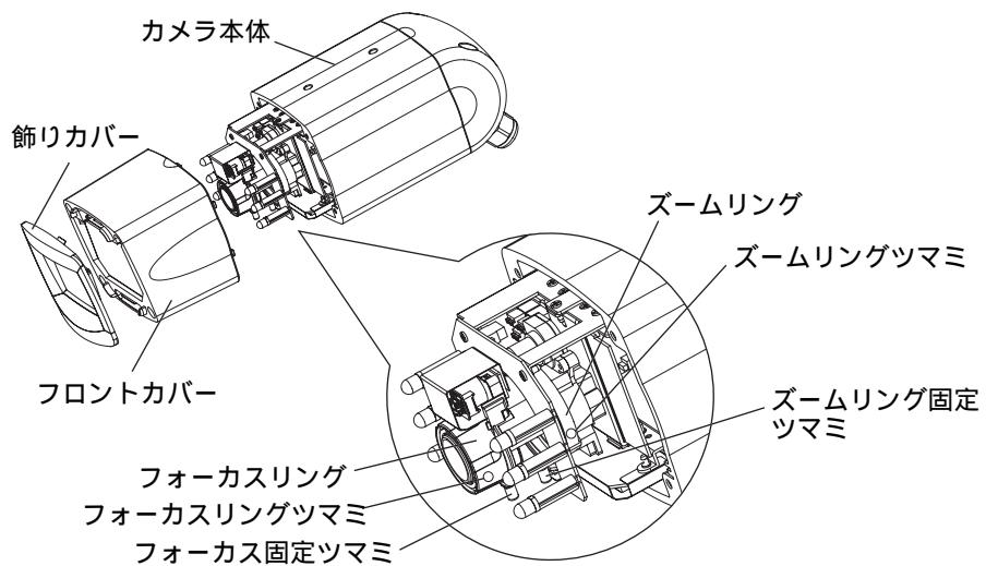
レンズ調整、DIP SWによる設定、OSDによる設定が終了したら、フロントカバー、飾りカバーを取り付けてください。
