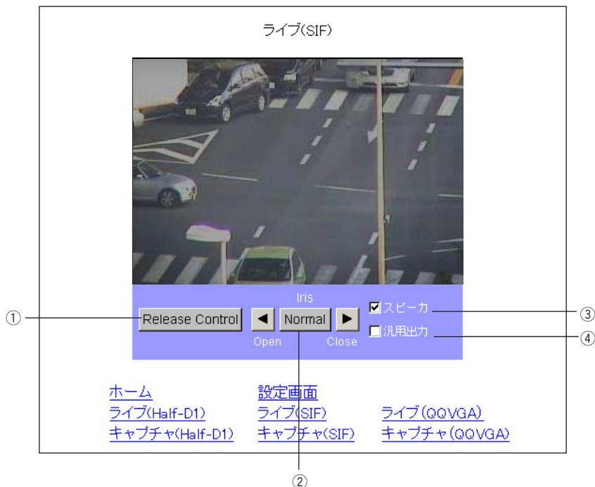
①Release Control .....カメラコントロール設定 (P.44) で制御権管理が時分割に設定されている時に有効で、カメラの制御権を開放します。制御権を要求するクライアントが他にいない場合は開放しません。
