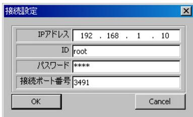
4. 接続したいカメラのタイトル、IPアドレス、ログイン名、パスワード、接続ポートを入力し、[ OK ] ボタンを押すとカメラに接続され、画面にMPEG4映像とカメラコントロールパネルが表示されます。
