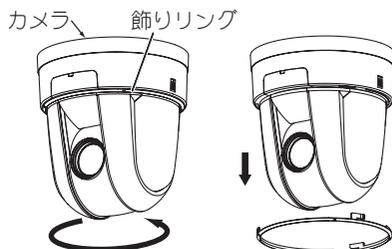
2. ドームカバーの突起無し部とカメラのリモコン受光部の方向を合わせます。
