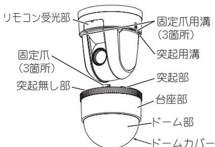
3. ドームカバーの固定爪 (3箇所) に挿入し、右に回します。
