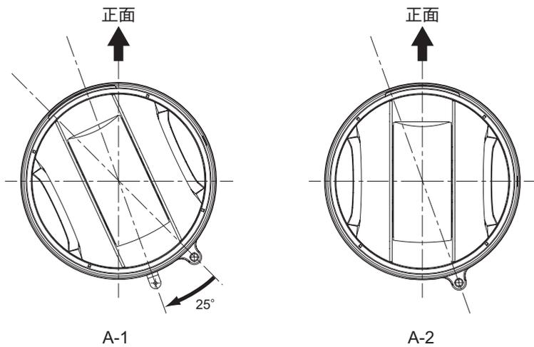
5. 本機と天井取付金具を、付属の固定ネジで固定します。
