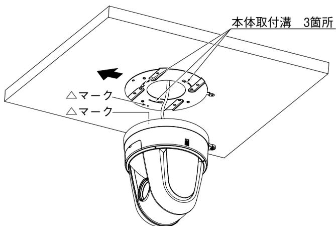
4. 天井取付金具の溝（3箇所）へ本機裏の爪部（3箇所）を差し込み、時計回りで25°回します。
