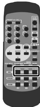
フロント操作パネルとリモコンの【IRIS・OPEN】ボタンと【IRIS・CLOSE】ボタンを押すと、レンズの絞りを調整して映像の明るさが調整されます。この調整には下記の二つの調整モードがあり、OSDの【Iris】の項目で、各モードを設定します。
