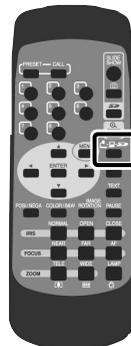
フロント操作パネルまたはリモコンの [ - - ] ボタンを押す毎に、カメラ映像、アナログRGB入力端子 [ RGB IN ] に入力された映像、SDカードに保存された画像が切替ります。
