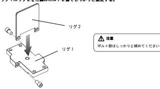
2. カメラ2台を1で組み立てたベースに付属のボルト4個でしっかりと固定する。
