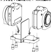
3.QBiC CS-1用リグの底部三脚ネジを利用し、対象物にしっかりと固定する。
