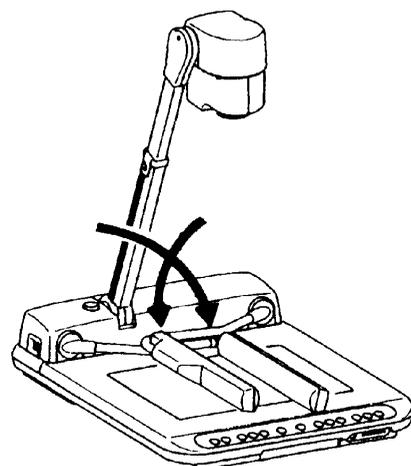
③カメラヘッド部を支柱に対して図の位置まで回転させます。
