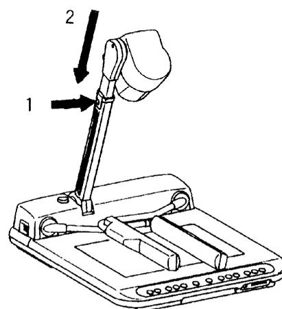
⑤支柱ロック解除ボタン (UNLOCK) を押してロックをはずし、支柱を倒します。
