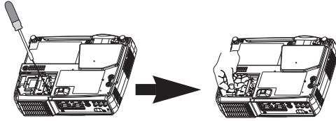
**5** 新しいランプを取り付け、1本のネジをしっかりと止めて固定する
