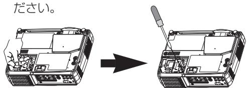
**6** ランプカバーをもとのように取り付け、2本のネジをしっかりと止めて固定する
