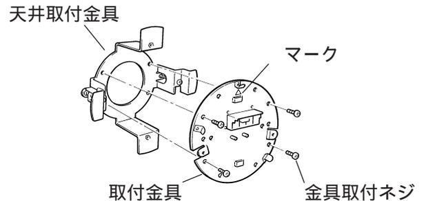
(4) 同軸ケーブルを接続後、天井取付金具を天井面に取付けます。
