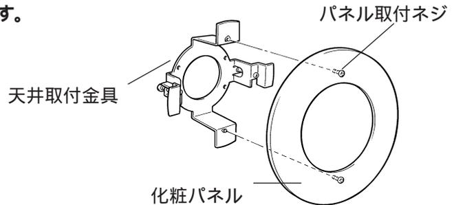
(3) 天井取付金具にドームカメラの取付金具を付属の金具取付ネジ4本で取付けます。
