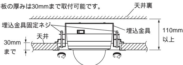
(6) 埋込金具を天井に固定後化粧パネルをパネル取付リベット2個で取付けてください。
