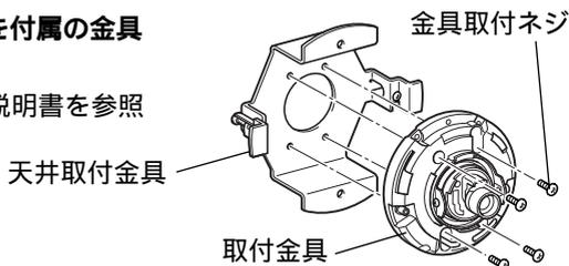
(4) ケーブルを接続後、天井取付金具を天井面に取付けます。
