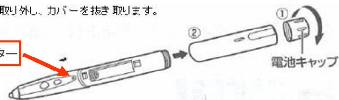
2. 付属の乾電池(単4形)を図の向きに入れ、カバーと電池キャップを取り付けます。
